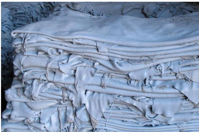
Figura 3.3 – Pilha de peles em estado wet-blue
