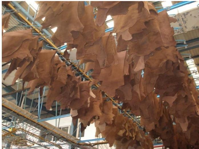
Figura 3.6 – Secagem de peles em transportador aéreo às condições ambientais
