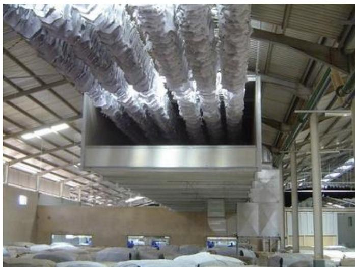
Figura 3.7 – Secagem de peles em transportador aéreo com estufa
