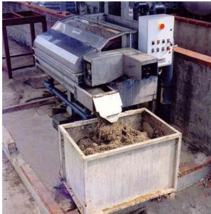
Figura 3.14 – Equipamento de separação do pêlo
