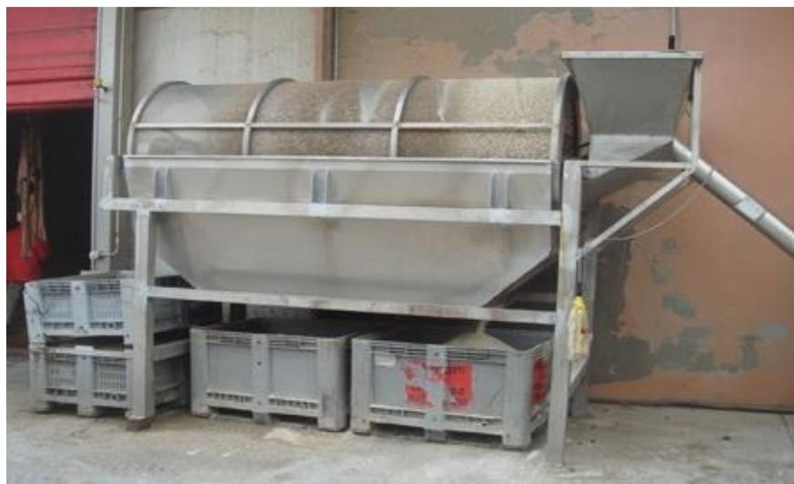
Figura 3.9 – Equipamento para filtragem de sal recuperado
